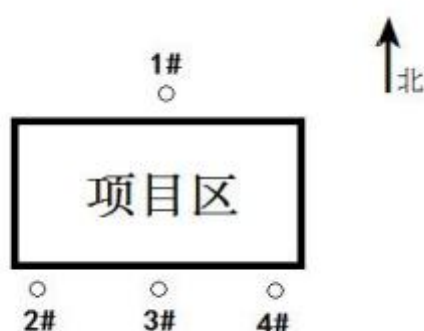
图 2 无组织 VOCs 监测布点示意图（“○”表示无组织检测点位）
