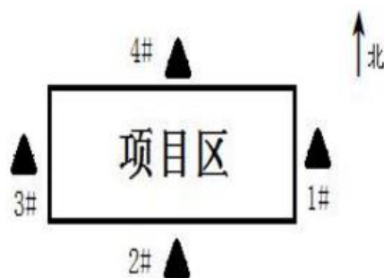
图3 噪声监测布点图（“▲”厂界噪声监测点位）
