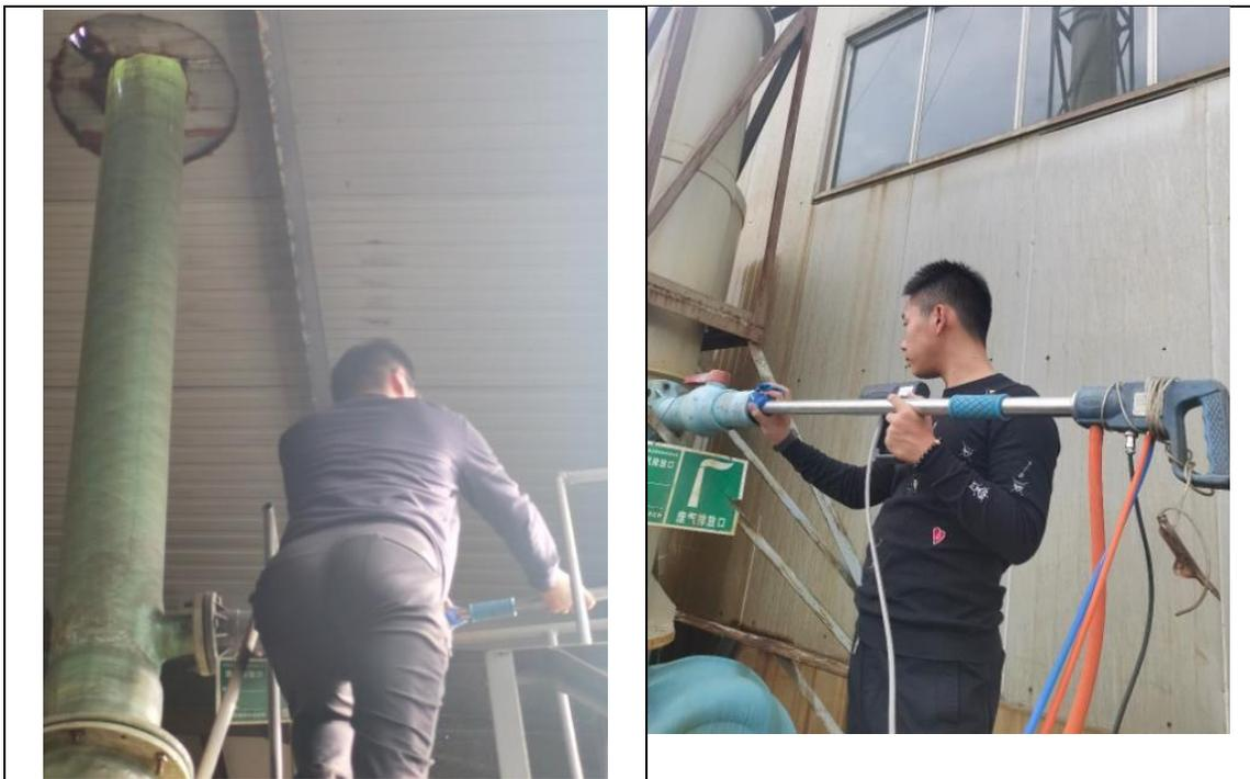
有组织废气现场检测照片
