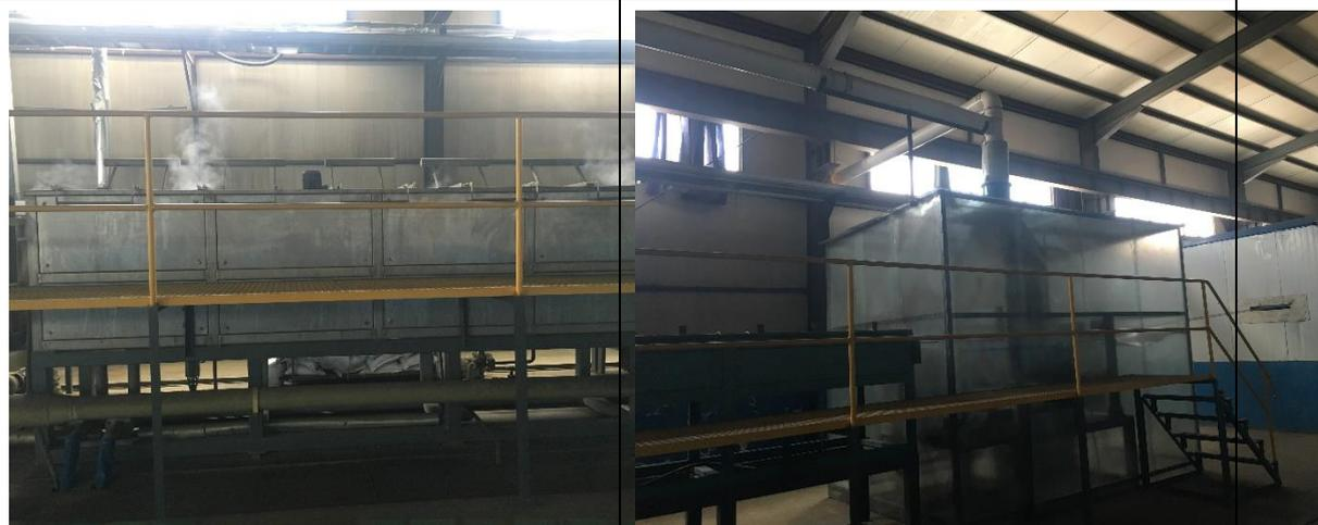
镀铜工序-水洗、弱碱洗、水洗、热水洗
