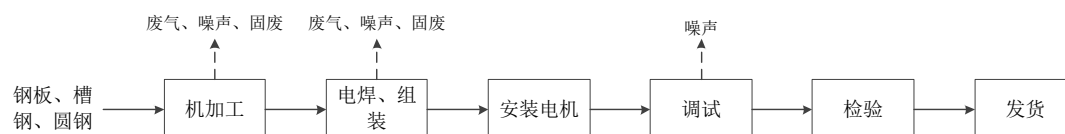
图3 除锈设备工艺流程及产排污环节图
