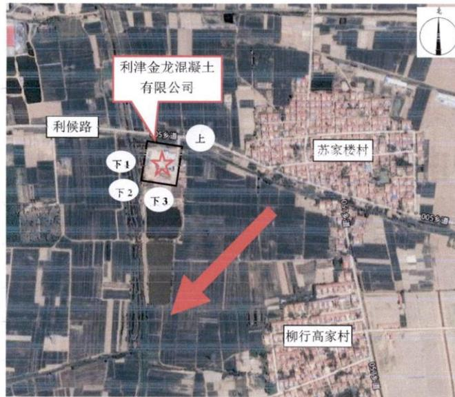
图 1 无组织废气采样点位置示意图(2018.2.20)
