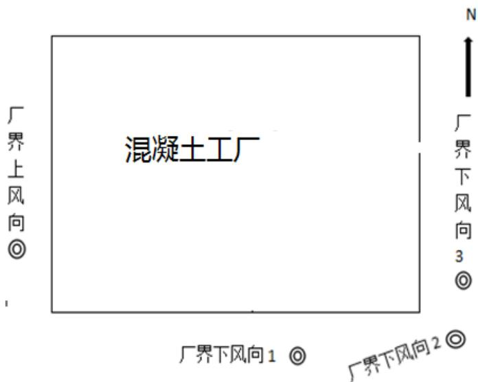
图 7.1-1 无组织监测布点图 (“⊙”无组织监测点位)
